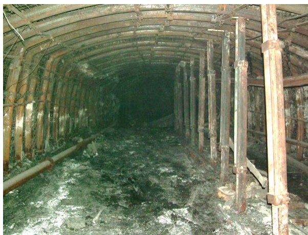
Rys. 1. Widok rozciętki ścianowej rozruchowej w obudowie ŁPrP podbudowanej stojakami stalowymi w rozstawie odrzwi obudowy co 0,5 m w rejonie wpływu krawędzi eksploatacyjnych
