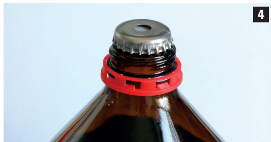
Fot. 4 Butelka zabezpieczona membraną silikonowo- teflonową (tzw. septą), chroniącą zawartość opakowania przed wilgocią i tlenem z powietrza, umożliwiającą pobieranie reagentów za pomocą strzykawki (w butelce znajduje się bezwodny dimetylosulfotlenek – DMSO)
