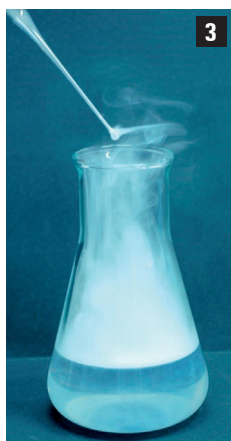
Fot. 3 Reakcja \text{TiCl}_4 z wodą – zwróć uwagę na mgłę złożoną z produktów hydrolizy
