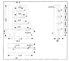
Fig. 20. The CRC mould schematic [56].
