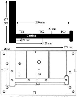
Fig. 23. The horizontal rod mould [17,32]
