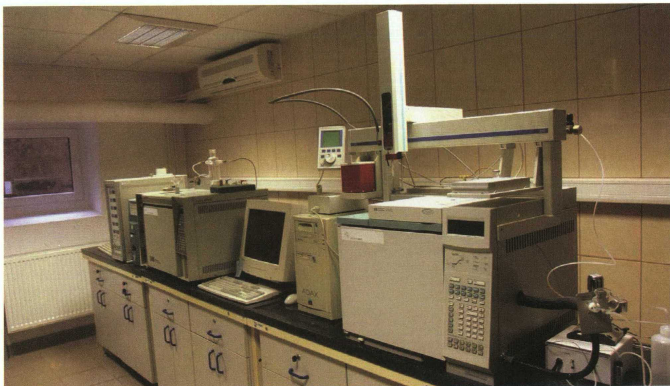
Chromatograf gazowy z portem olfaktometrycznym – Laboratorium Zakładu Koncentratów Spożywczych UP Poznań
