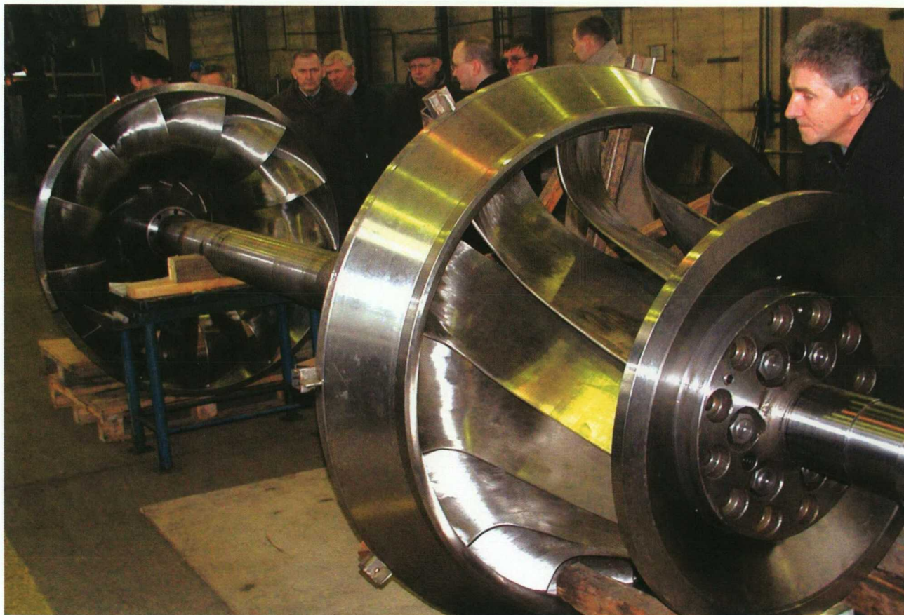
Współpraca pomiędzy Instytutem a elektrowniami wodnymi - na zdjęciu naprawiany wirnik
