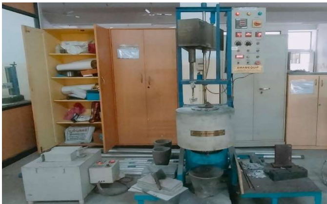
Fig. 2(a). Rheo stir casting setup
