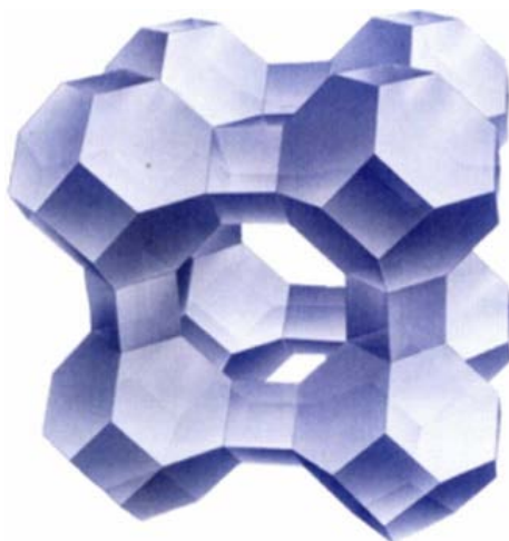
Rys. 1. Model przestrzennego połączenia kubooktaedrów w zeolicie typu A ( http://www.molecularsieve.org )
