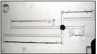
Fig. 2. Mold for Althoff-Radtke test
