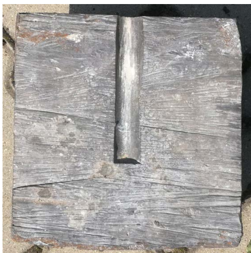
Rys. 2. Przekrój poprzeczny przez blok ołowiany – przed odstrzałem
