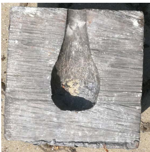
Rys. 3. Przekrój poprzeczny przez blok ołowiany – po odstrzale
