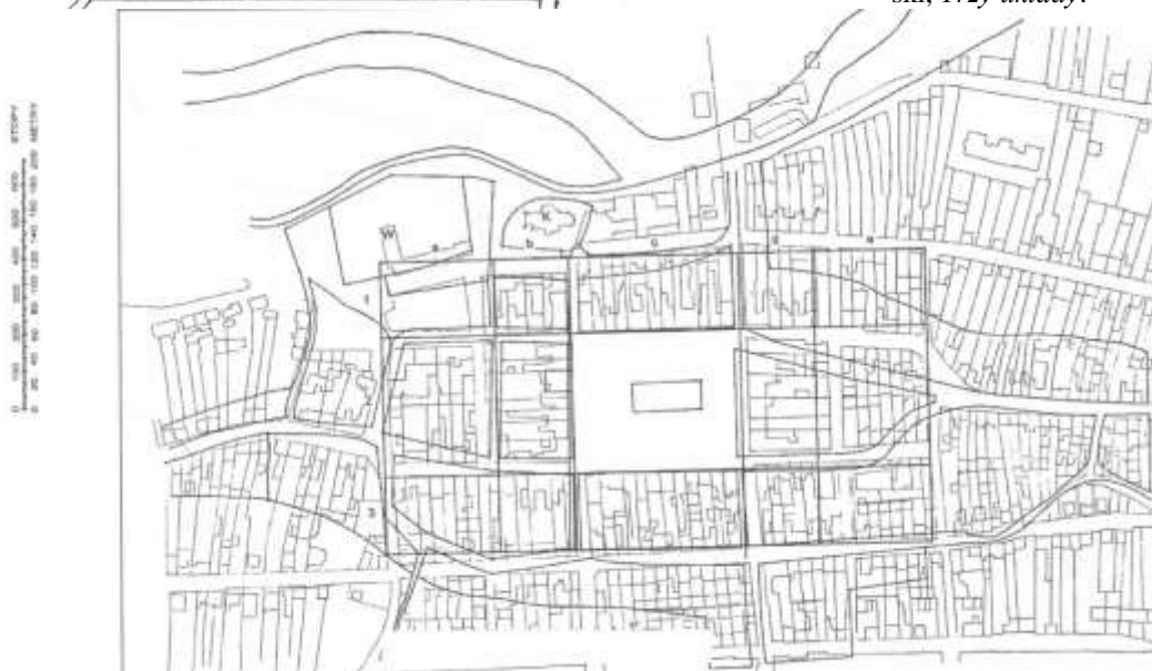
Il.7. Analiza trzech układów urbanistycznych Nowego Targu w oparciu o przekazy planistyczne z lat 1784 i 1848; czytelne: domniemany układ pasmowy sprzed 1327 r.; układ szachownicowy, 1336 (zasady modularnego rozmierzenia oznaczone a-e, 1-3); układ z ok. 1784 r. rozmierzony w sążniach wiedeńskich (sieć uliczna i podziały własnościowe zbliżone do stanu obecnego). Opr. autor, repr. wg B. Krasnowolski, Trzy układy .
