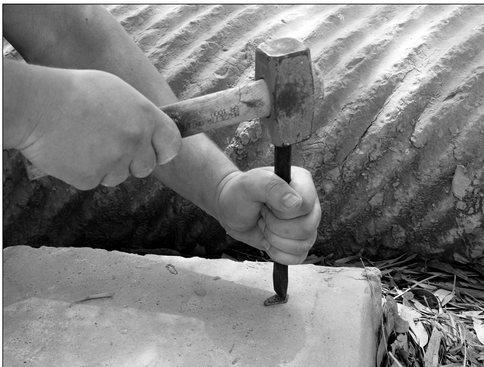
Ryc. 1. Jedna z metod cięcia blachy brązowej. Doświadczenie z użyciem dłuta płaskiego przeprowadzone przez konserwatora Radosława Tusznio (ASP w Warszawie) w Ptolemais wiosną 2010 r. Fot. P. Jaworski
