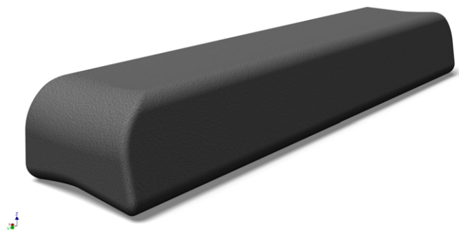
Fig. 1. An ingot of aluminum alloy EN AC 51200
