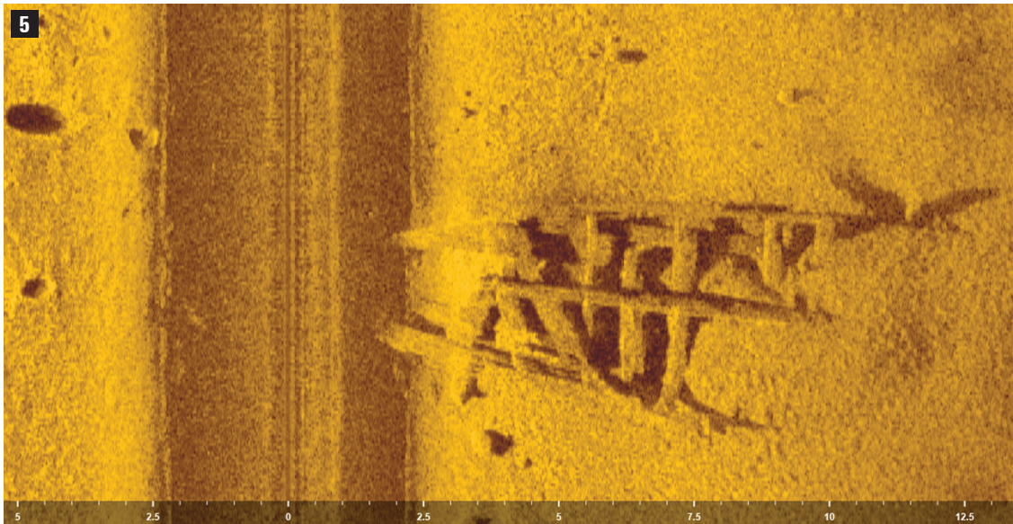
Fot. 5 Wrak statku przy praskiej plaży w Warszawie, częściowo ukryty pod piaskiem. Widoczne są zarysy burt, denniki oraz znajdujący się wzdłuż osi wraka długi element, przypuszczalnie maszt. Oprac. Andrzej Szerszeń
