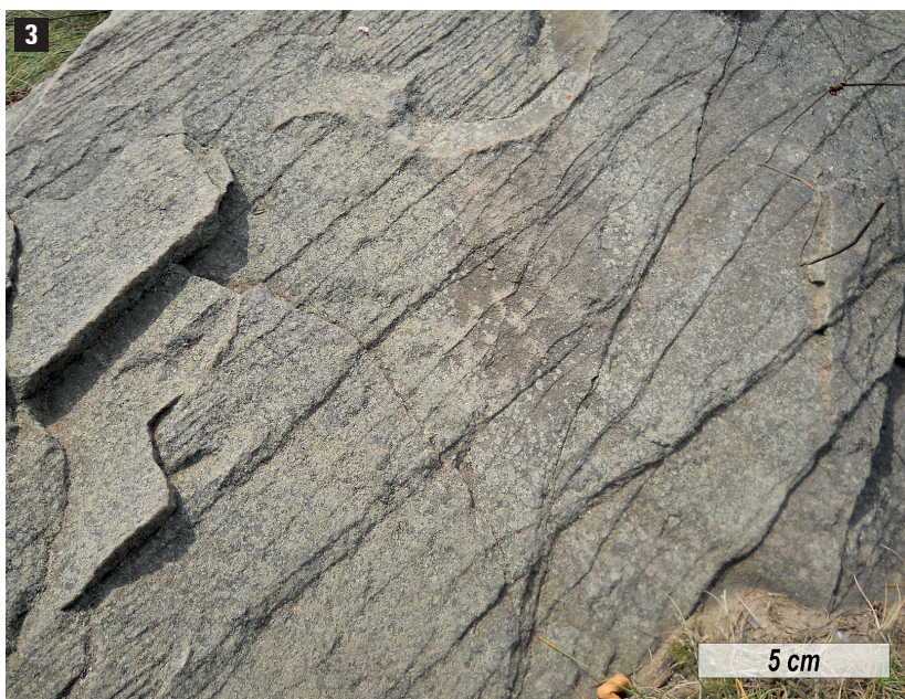
Rys. 3 Powierzchnia piaskowca z licznymi wstęgami deformacyjnymi
