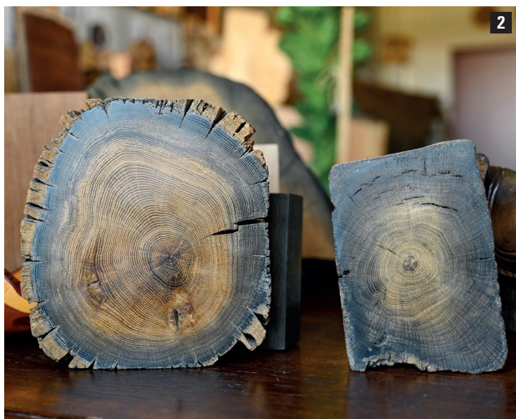
Fot. 2 Drewno archeologiczne – elementy konstrukcyjne z 1346 roku wykopane na Starym Mieście w Gdańsku (czarny dąb)
