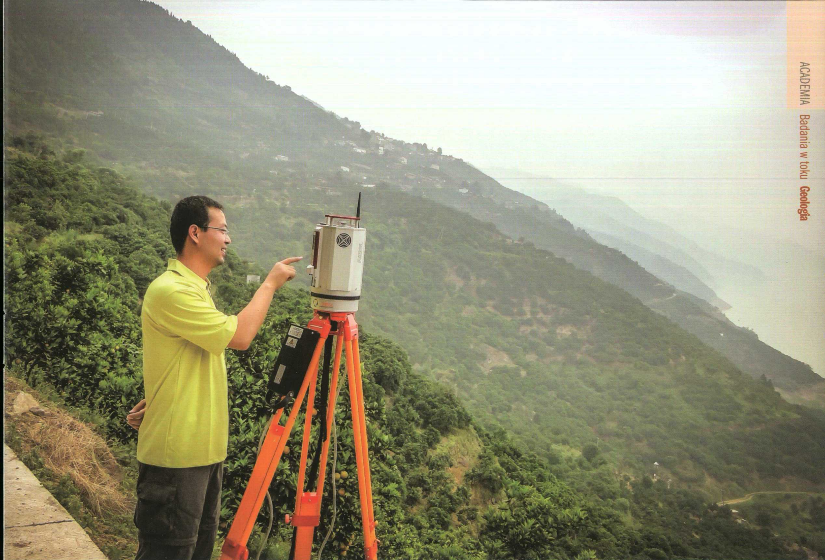
Skanowanie osuwiska Shuping. Dr Fan Jinghui ustawia parametry skanowania laserowego
