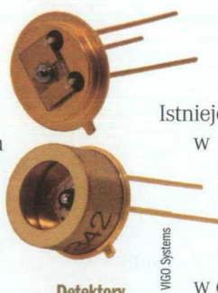
Detektory podczerwieni wyprodukowane przez polską firmę VIGO Systems, które poleciały na Marsa z misją Curiosity
