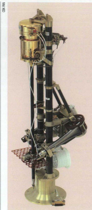
Skonstruowany w CBK PAN dla misji ROSETTA zestaw Penetratora MUPUS
