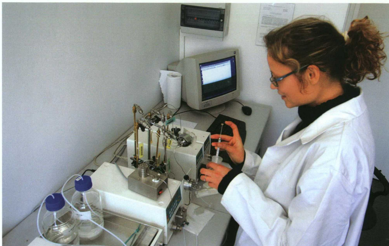
Chromatograf cieczowy (HPLC) służy do oczyszczania, identyfikacji i badania struktury substancji chemicznych
