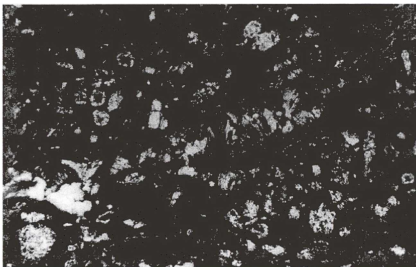
Fot. 1. Zlepnicie tufowy barwy zielonej po hydrotermalnej syntezie. Mikrostruktura porfirowa. Wśród prakryształów dominują listewkowe ziarna piroksenów i oliwinu. Nieliczne kuliste skupienia zeolitów rozproszone w masie skalnej. Nikole skrzyżowane. Pow. 100x
