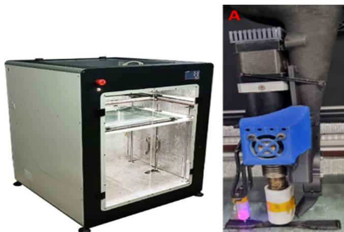
Fig. 1. Pellet 3D printer
