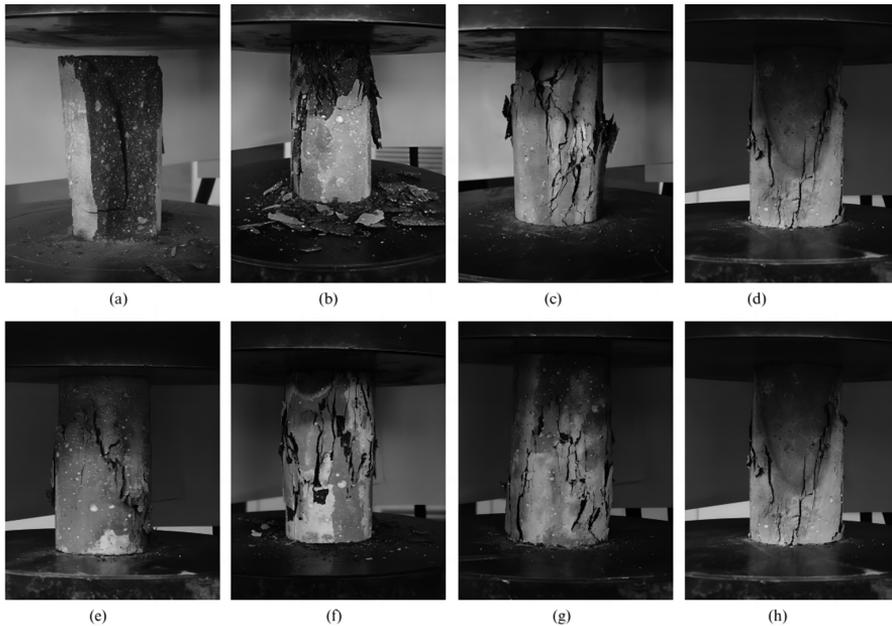
Fig. 7. Macro-failure morphologies of UHSRC specimens under three kinds of rubber particle sizes [22]: (a) R0<sup>o</sup>%-SF0%, (b) R0<sup>o</sup>%-SF3%, (c) 0.85-R10<sup>o</sup>%-SF3%, (d) 0.85-R20<sup>o</sup>%-SF3%, (e) 0.85-R30<sup>o</sup>%-SF3%, (f) 4-R20<sup>o</sup>%-SF3%, (g) 2-R20<sup>o</sup>%-SF3%, (h) 0.85-R20<sup>o</sup>%-SF3%
