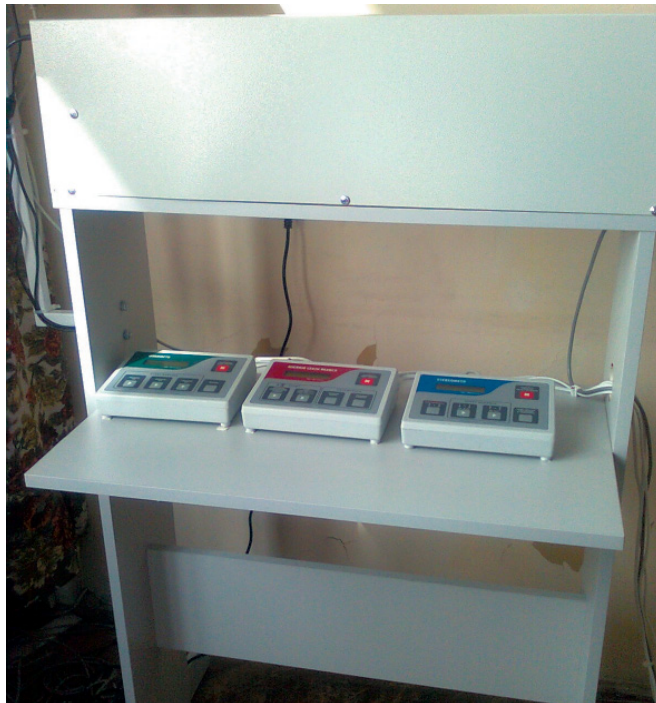
Fot. 4. Panele sterownicze stereometru Dolmana, wirometru oraz miernika czasu
