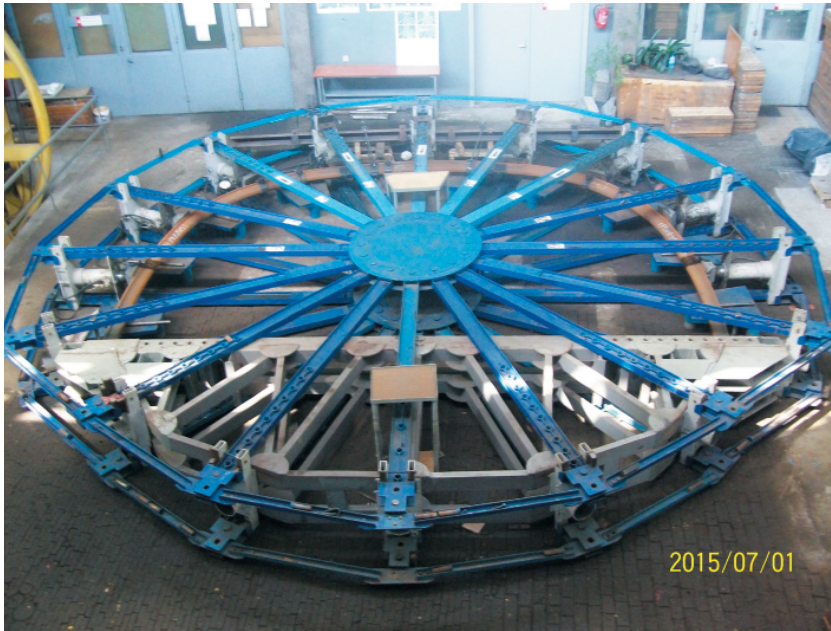
Fot. 5. Stanowisko do badań obudów górniczych
