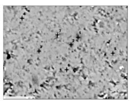
Fig. 4. BSE image of a sample W5 (Górażdże limestone from Wysoka) (Stanienda, 2013a).
